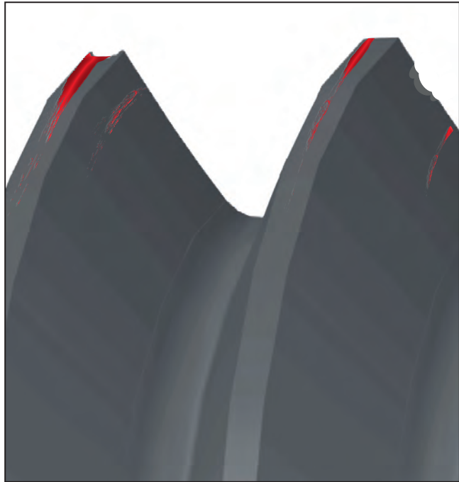
Schadbild bei hoher Partikelbelastung, Schneidenausbrüche und Schäden am Gewindebohrer durch klemmende Partikel
