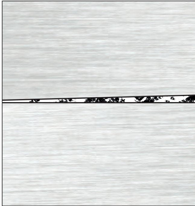
Nullpunkt-Spannsysteme: Abgelagerte Verschmutzungen beeinträchtigen die Präzision
