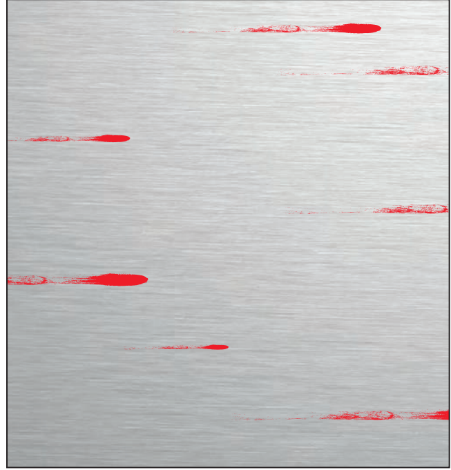
Asılı tanecikler ve parçacıklar yüzeye ve taşılama diskine zarar verir
