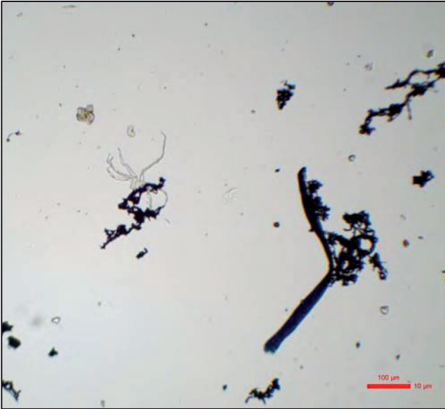
Devam eden büyük ölçekli üretimden soğutma yağı örneği. Bant filtre sistemine rağmen partikül boyutları istenilen toleransların ve yüzey pürüzlülüğü değerlerinin çok üzerinde!
